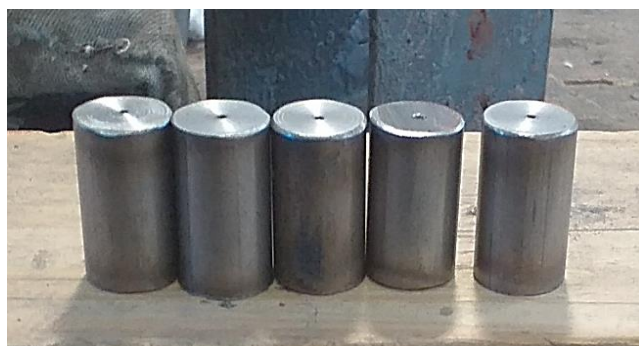
Figura 3 Probetas a utilizar durante los diversos experimentos en el cual es visible el barreno dónde fueron instalados los termopares
