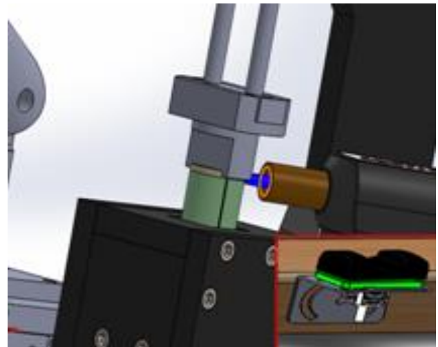
Figura 6 Unión del cap con el tubo por medio de lámparas leds
