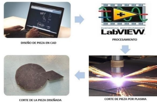
Figura 6 Proceso para cortes por plasma.
