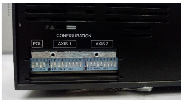
Figura 9 Configuración de corriente del MID-7652. Fuente: Elaboración Propia
