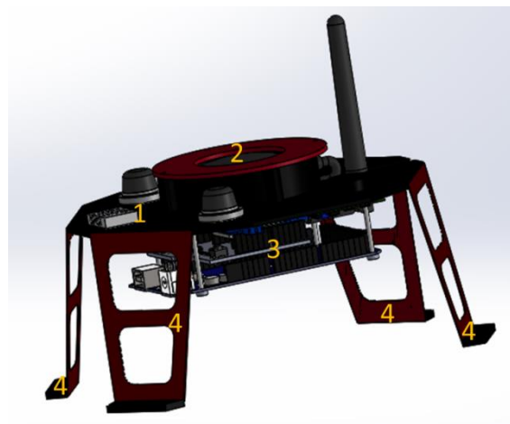
Figura 6 Diseño de estructura para soporte de unidad
