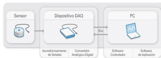
Figura 2 Partes que componen un sistema DAQ de monitoreo de variables físico-eléctricas
