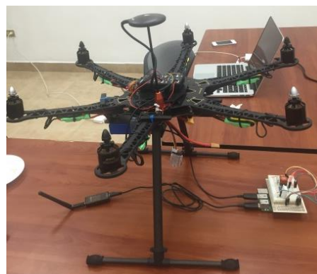
Figura 4 Plataforma VANT tipo hexacoptero modelo Tarot S550 con autopiloto Pixhawk con interfaz de comunicación diseñada
