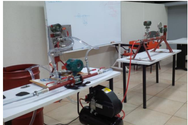
Figura 3 De izquierda a derecha: el patín de medición de flujo y presión diferencial y el patín de medición de presión y temperatura
