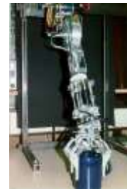
Figura 1 Robot basado en los rangos de movimiento del brazo humano.
