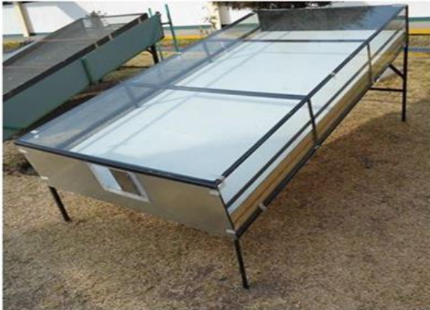
Figura 8 Equipos de deshidratación de frutas y verduras Fuente: CAIP
