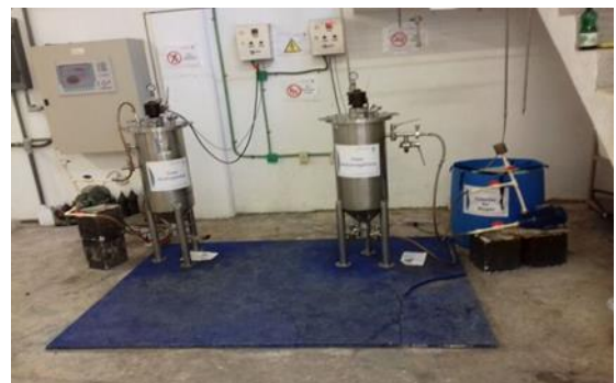
Figura 1 Sistema de digestores anaerobios en fases
