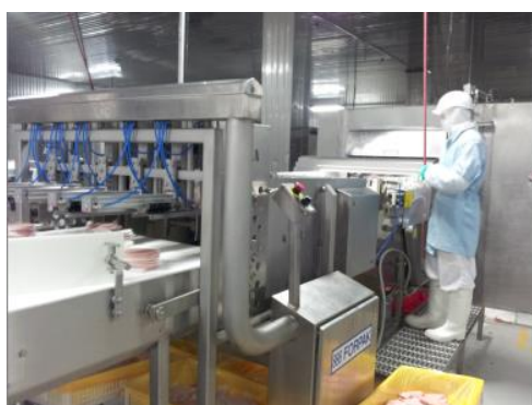
Figura 14.4 Máquina de apilado de hamburguesa y detectora de metales
