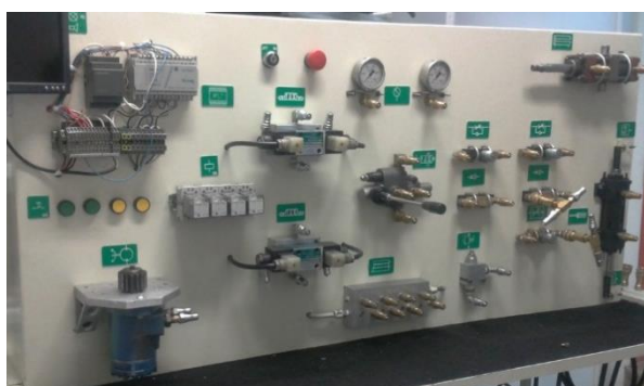
Figura 14.3 Banco de pruebas Hidráulicas
