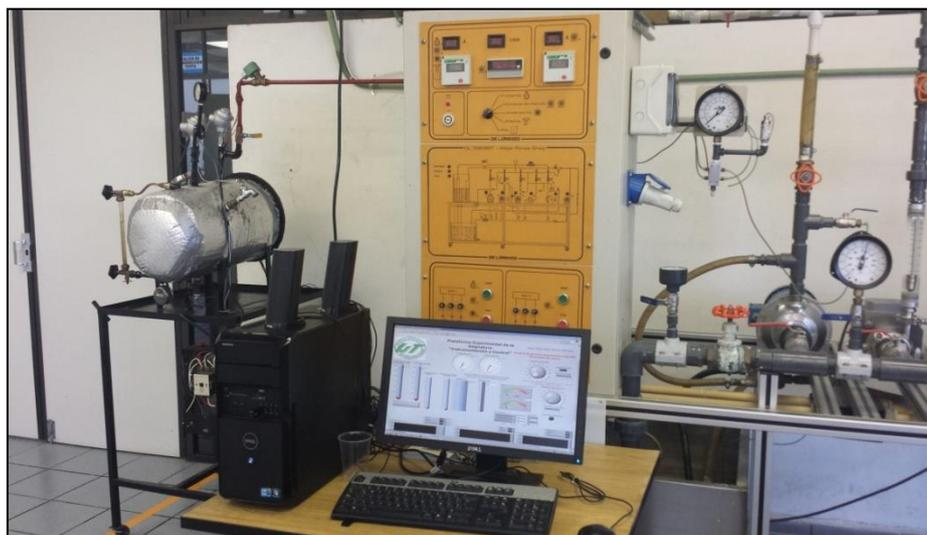
Para fines prácticos, se ha dividido la plataforma en dos partes principales: banco de pruebas para motobombas y generador de vapor eléctrico.
