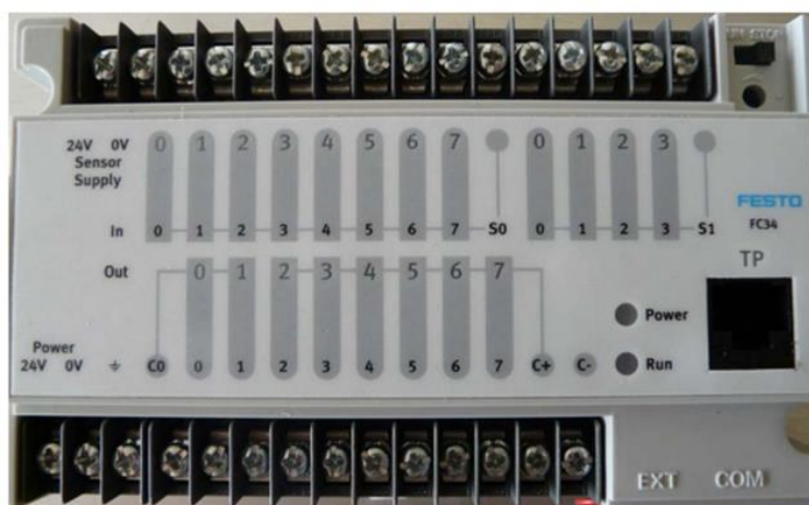
Figura 21.3 Controlador lógico programable de la marca Festo® modelo FC34
