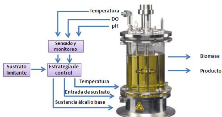
Figura 17 Diagrama a bloques del proceso de fermentación
