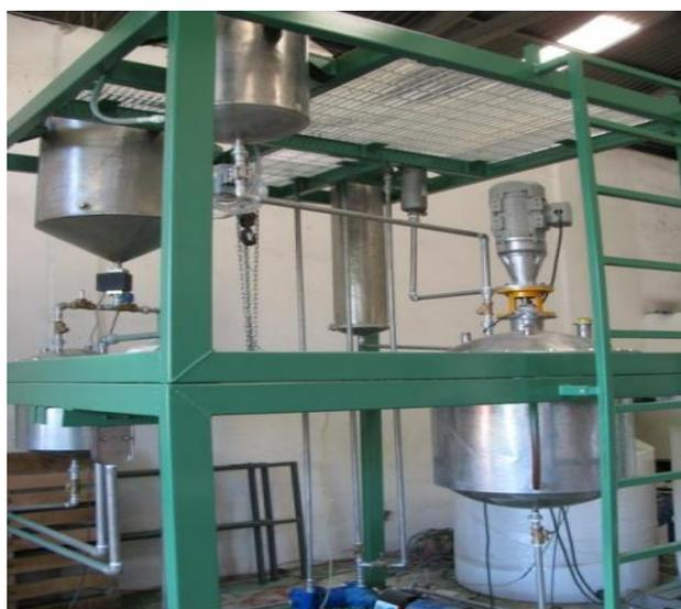
**Figura 1** Planta piloto para la producción de biodiesel
