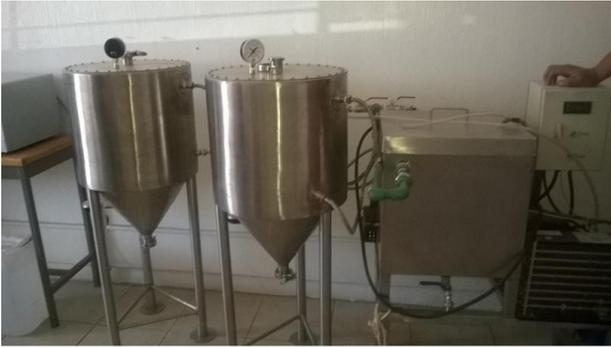
**Figura 4** Reactores para para la producción de biodiesel mediante aceites vegetales
