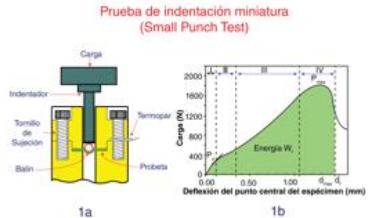
Figura 1 a) Esquema del dado de prueba y b) Curva carga-deflexión.
